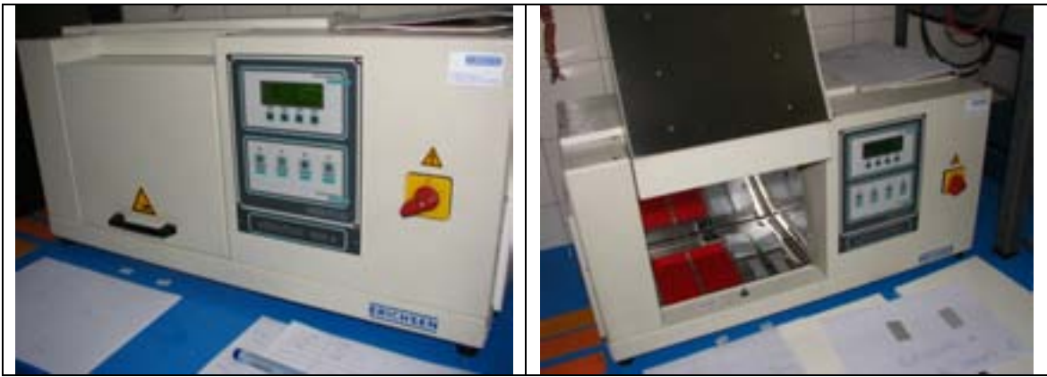
Slika 37. Komora za UV ispitivanje [29]
