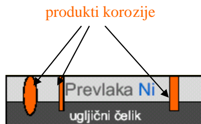
Slika 5. Katodna prevlaka nikla na čeliku [10]
