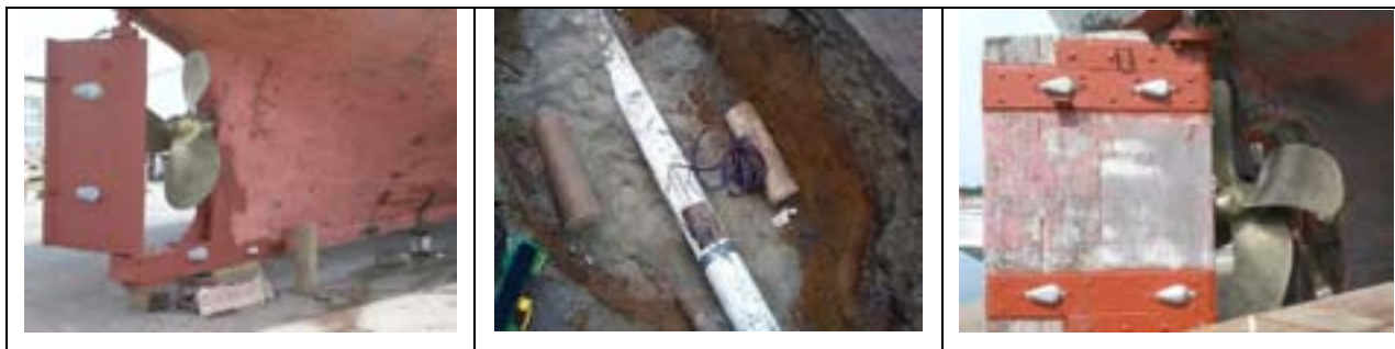
Slika 3. Primjeri katodne zaštite primjenom protektora [6]
