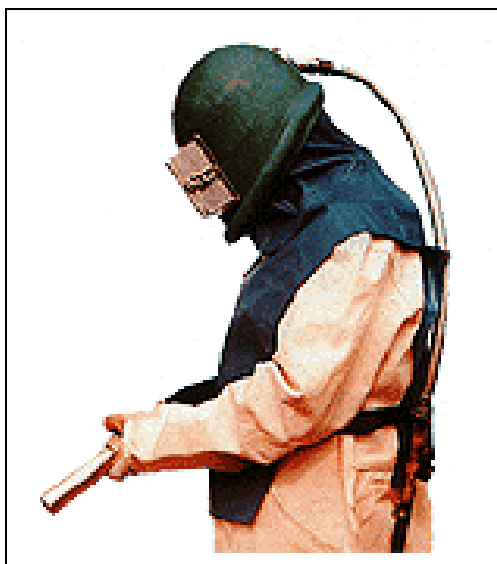
Slika 12. Radnik u skafanderu za pjeskarenje [22]
