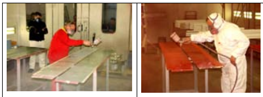
Slika 18. Nanošenje premaza na bazi otapala [29]
