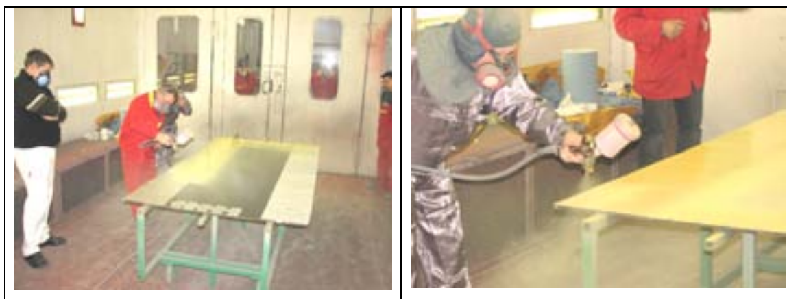
Slika 19. Nanošenje vodorazrjedivog temelja [29]
