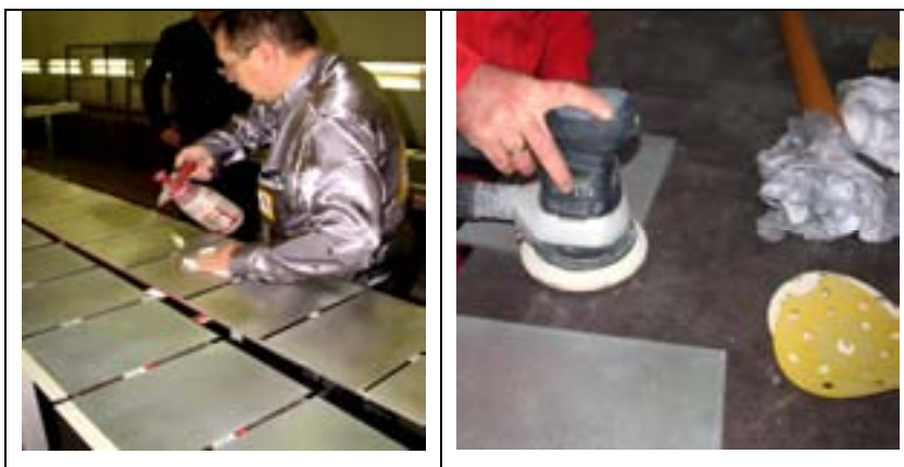
Slika 17. Detalji pripreme površine prije nanošenja premaza [29]
