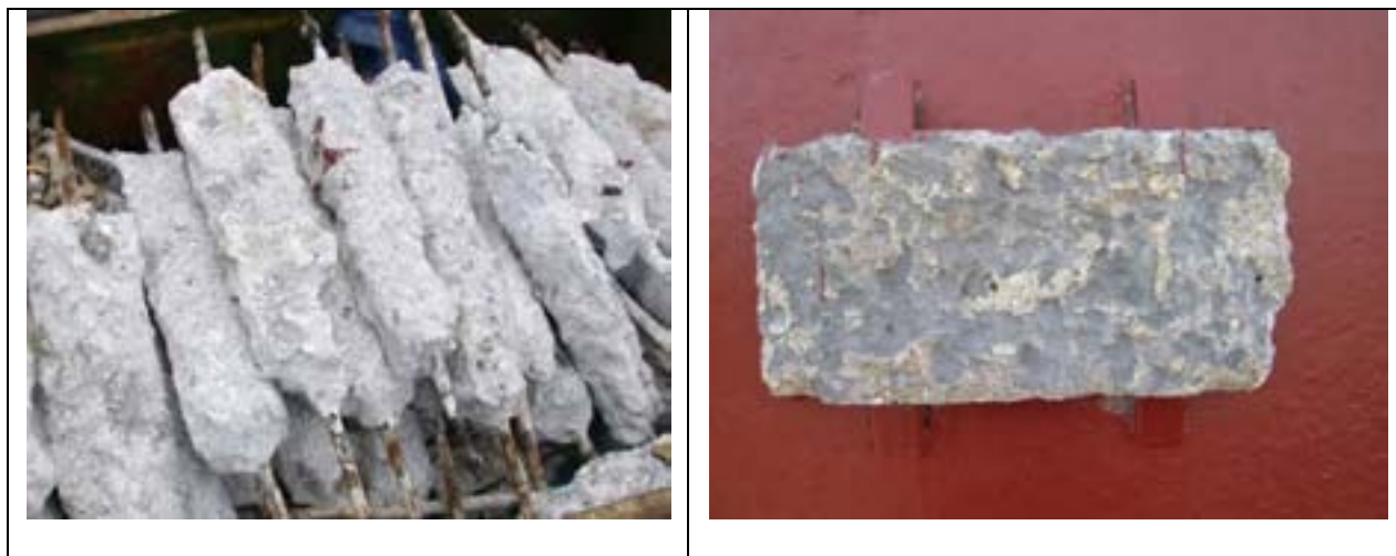
Slika 2. Primjeri istrošenih anoda [6]
